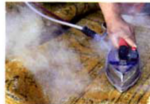
Mit Dampf werden der alte und neue Flor verbunden.
