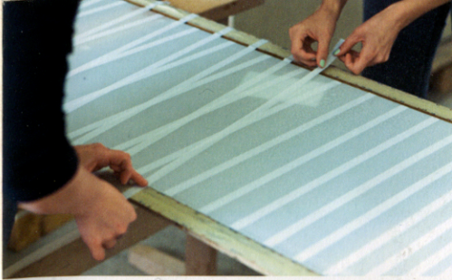
<Millimeterarbeit an der Scheibe: Die Streifen müssen präzise platziert werden.
